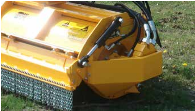
Optionaler Motorschutz und optionale hydraulisch hochklappbare Vorderseite zur besseren Zufuhr von hohem Mähgut.
