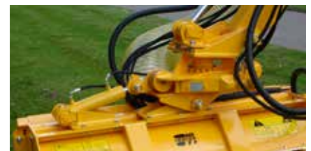
Hydraulischer Drehkopf 180° mittels Schneckenrad-Drehkranz mit hydraulischem Gelenklager (HWHP180).
