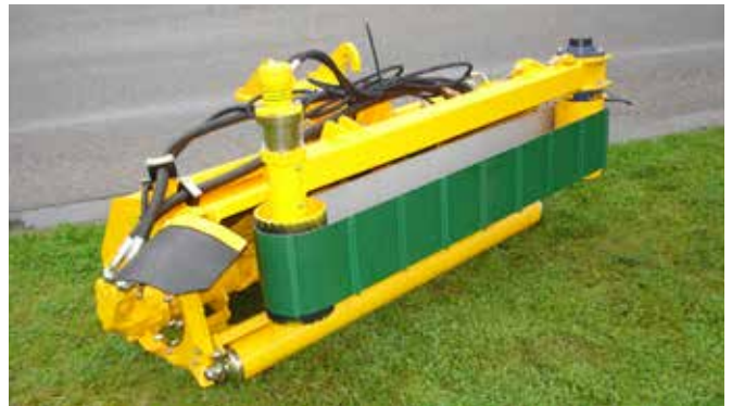
Förderbandeinheit in schwerer Ausführung zur Abführung des Mähguts beim Mähen von Gräben, Böschungen u. dgl.
