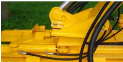
Hydraulischer Drehkopf 90° mittels Zylinder (HD90).
