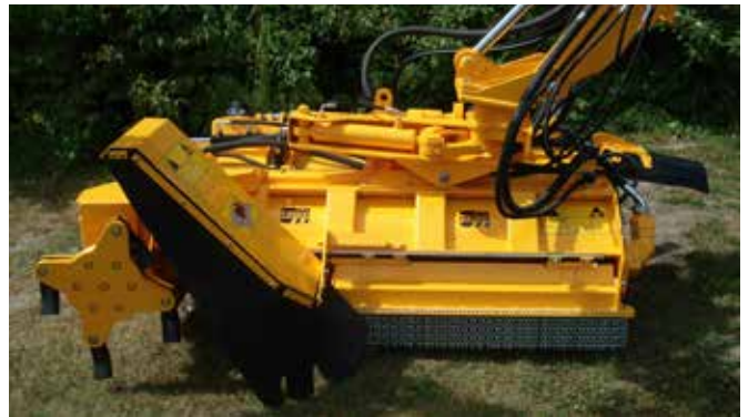
Bodenfräse zum Mähen von Grabenboden und Böschung in einem Arbeitsgang.
