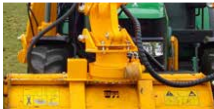
Hydraulischer Drehkopf 180 Grad mittels Schneckenrad-Drehkranz (HW180).
