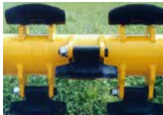
Transportschneckeneinheit zur Abführung des Mähguts mittels Absaugung.
