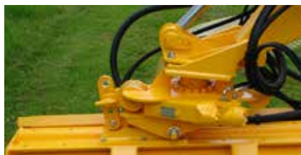
Hydraulischer Drehkopf 180° mittels Schneckenrad-Drehkranz mit mechanischem Gelenklager (HWP180).
