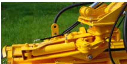
Hydraulischer Drehkopf 180° mittels Zylinder mit mechanischem Pendel (HDP180).
