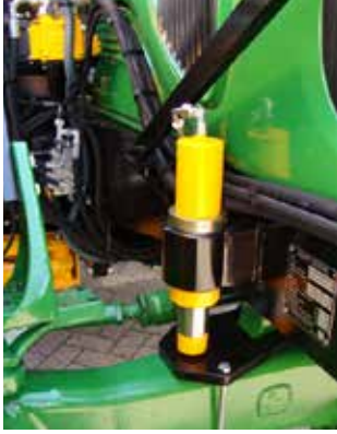
Vorderachsstabilisierung ist kein überflüssiger Luxus. Links vor einer festen Vorderachse und rechts vor einer gefederten Vorderachse.
