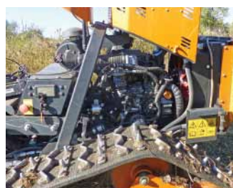
V. oben li. n. unten re.: Die Schaltzentrale des E-Trails. Der Antrieb des Mulchers erfolgt hydraulisch. Aufgebaut ist ein Dieselmotor von Yanmar. Die Wartungspunkte sind gut erreichbar.
